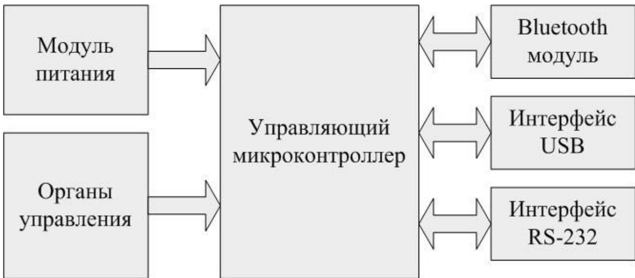
Рис. 2. Структурная схема пульта тренажера крановщика транспортно-заряжающей машины
