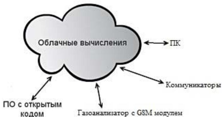
Модель взаимодействия облачных вычислений с газоанализатором и устройствами приема и передачи информации
