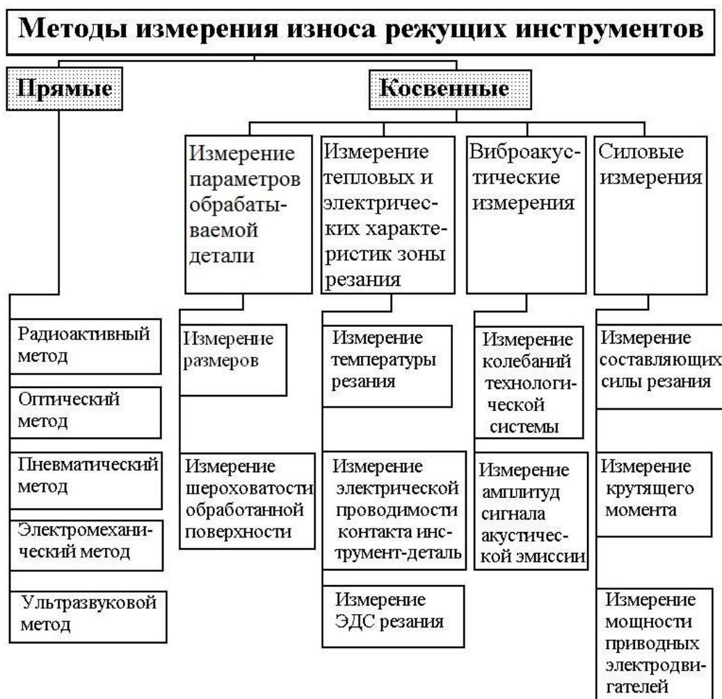
Рис.1 Методы измерения износа режущего инструмента
