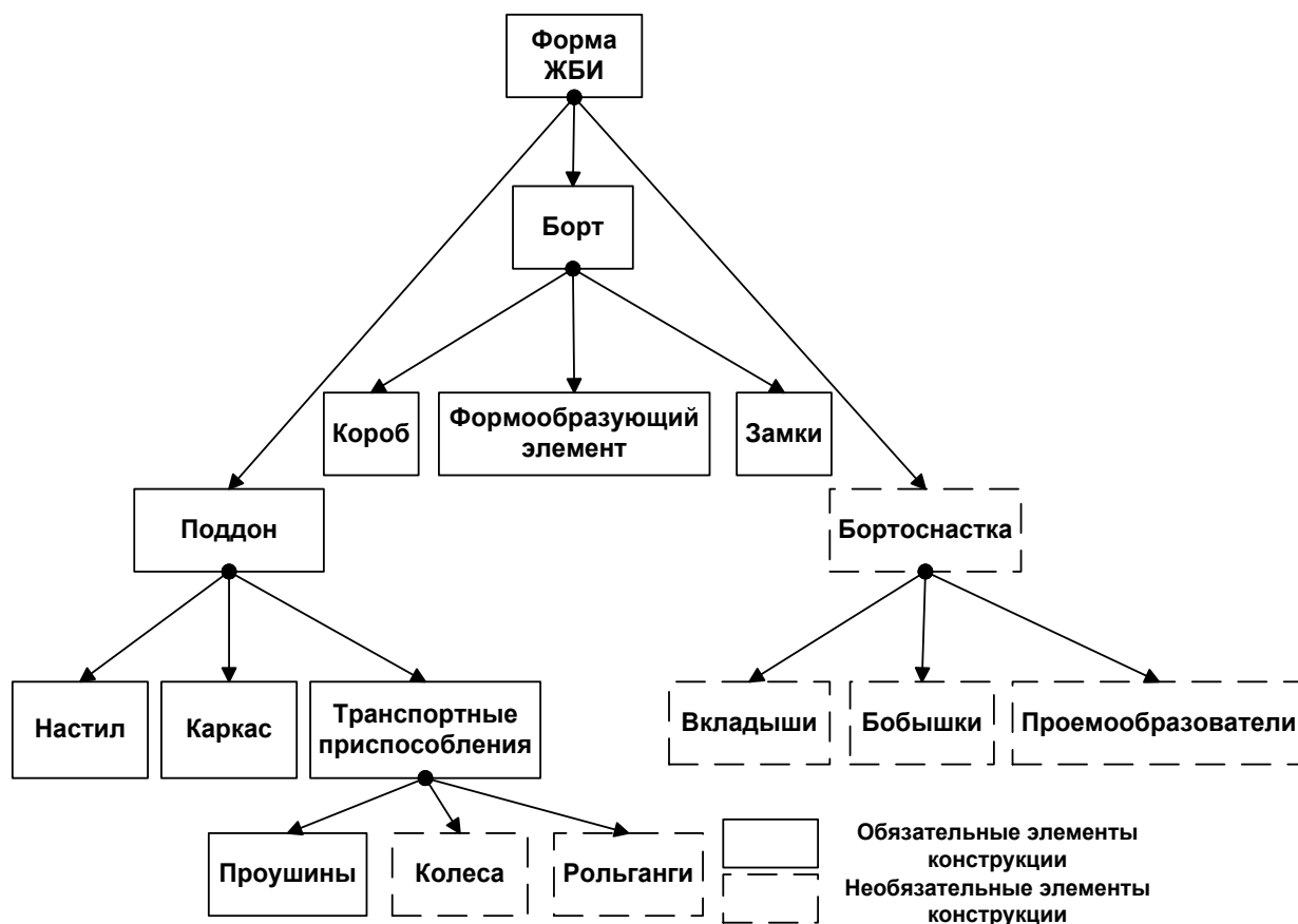
Рис.1 Схематическое представление конструкции стальных форм для изготовления ЖБИ
