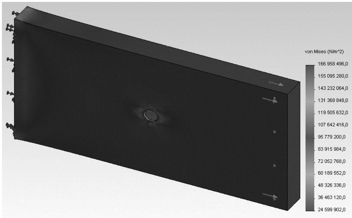
Рис. 1. Питтинг глубиной 0,1 толщины материала
