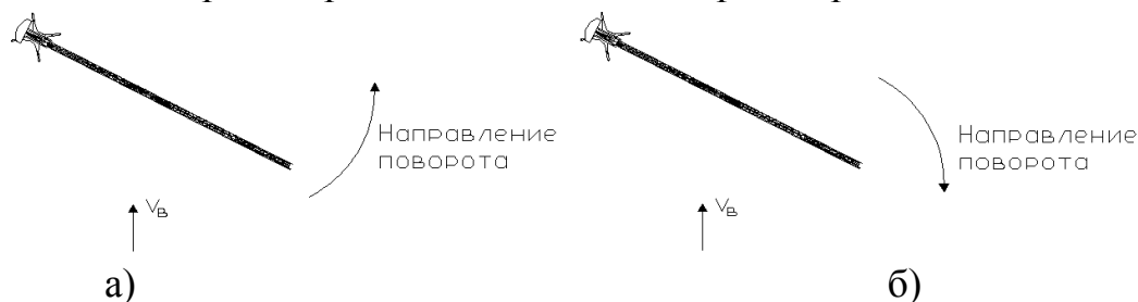
Рис. 1 Схема поворота стрелы при: а) пассивном управлении; б) активном управлении
