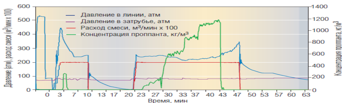
Рис. 3. Результаты обработки скважины 1981 на месторождении Сугмутское. Закачка проппанта на завершающей стадии приводит к увеличению давления, указывая на наличие эффекта образования повышенной упаковки проппанта
